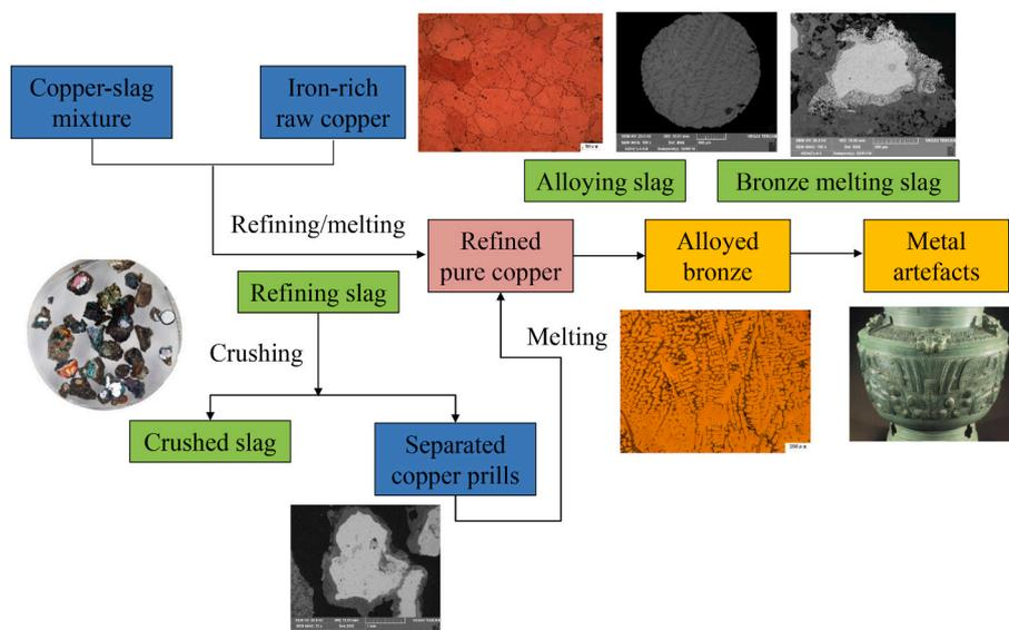
Fig. 13. The reconstructed metallurgical *Chaîne opératoire* at the site of Taijiyasi.
