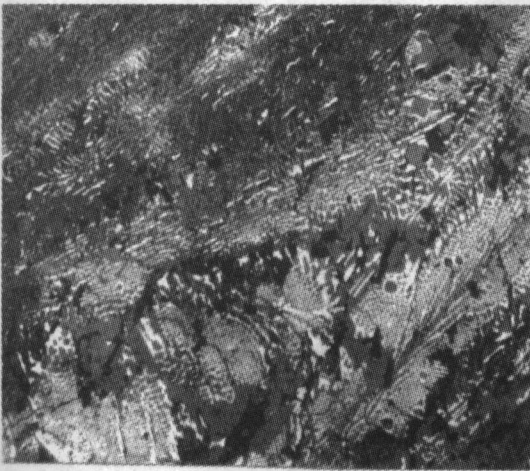
图三 2433 铁钎铸态白口铁 \times 100
