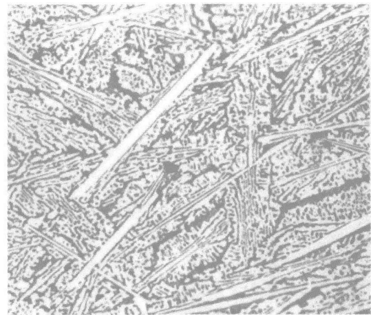
图八 铲 7134(M120:4)过共晶白口铁 ×100
