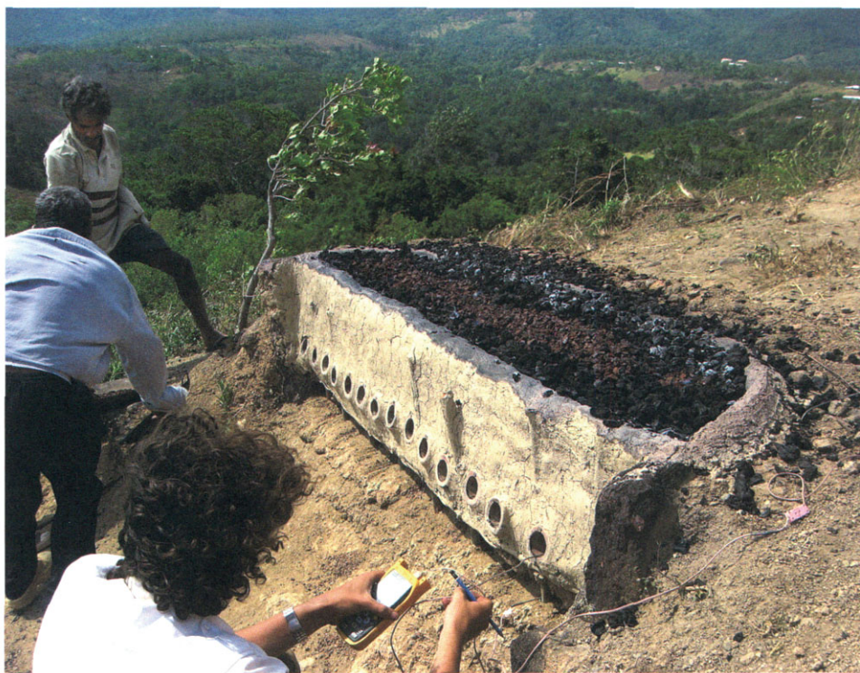
图六 斯里兰卡季风炼铁示意图
