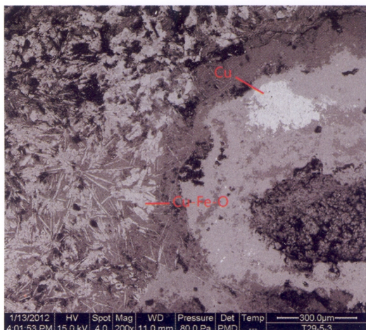
图一四 炉壁 (T29⑤:2) 粘附炉渣背散射电子像
