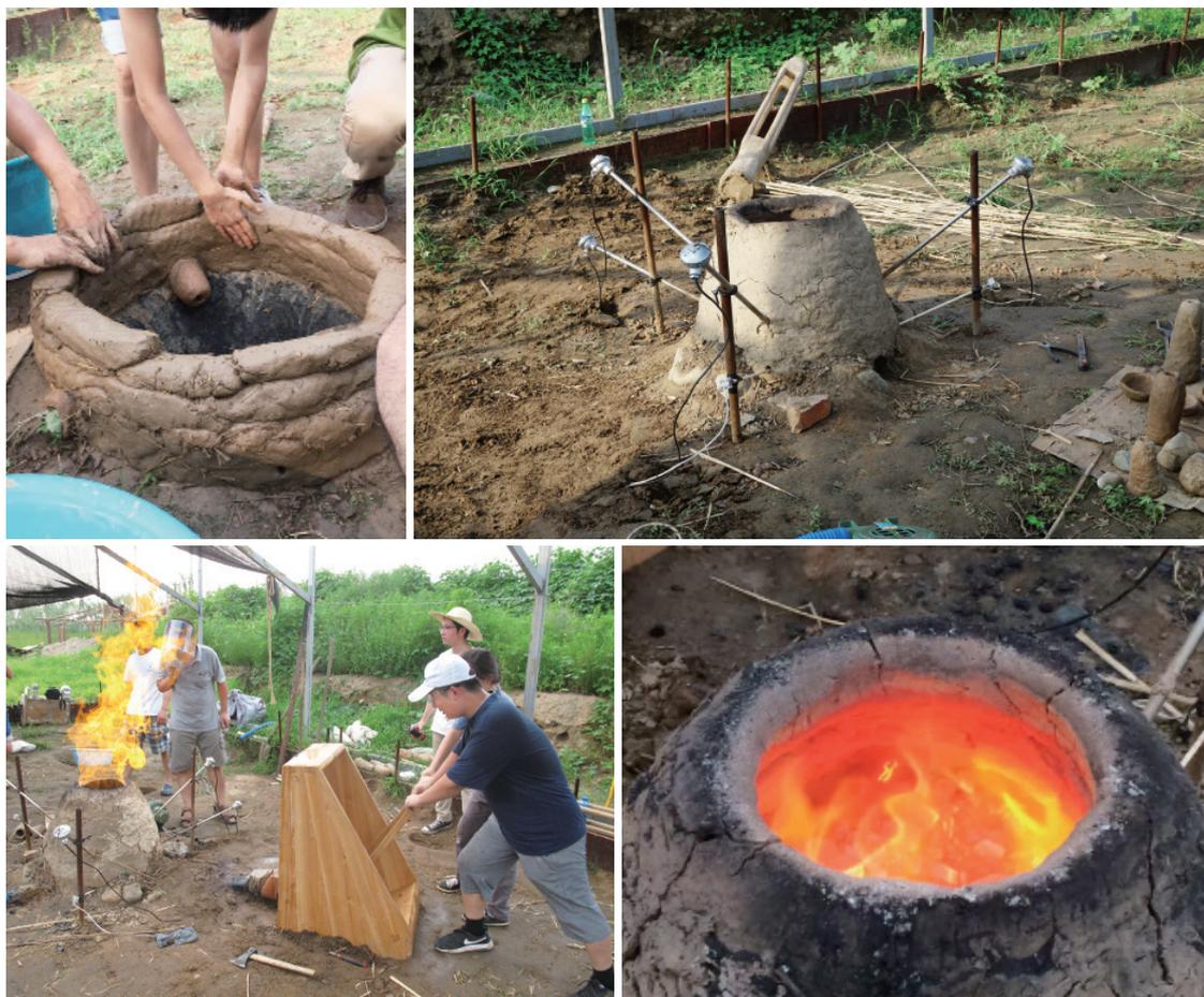
修筑的竖炉和利用竖炉冶炼场景
